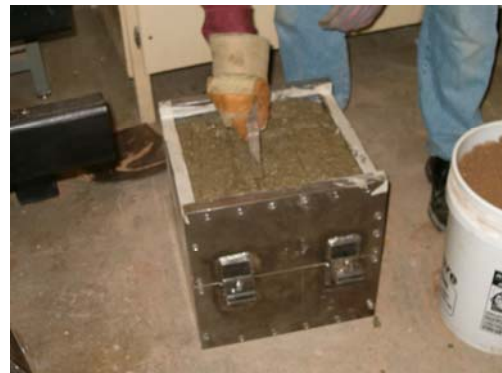
(d) Compacting Concrete
