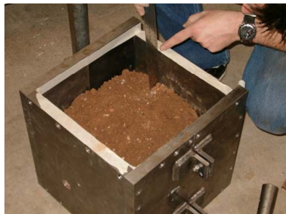
(d) Measuring layer thickness
